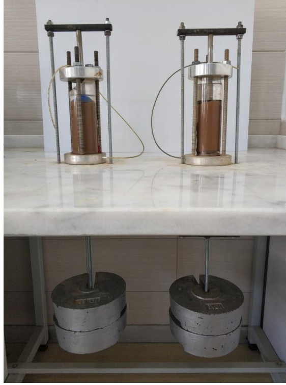
Şekil 4.6. 100 kPa altında tek boyutlu konsolidasyon işlemi.
