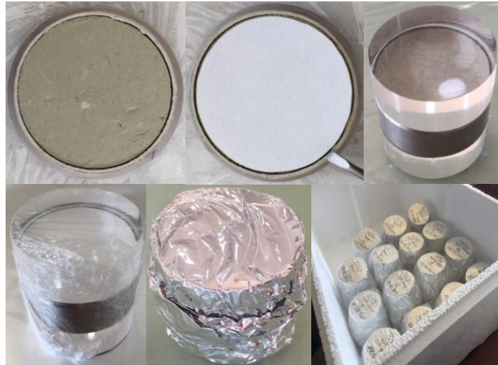
Şekil 4.10. Filtre kağıdı deney yöntemi detayları.
