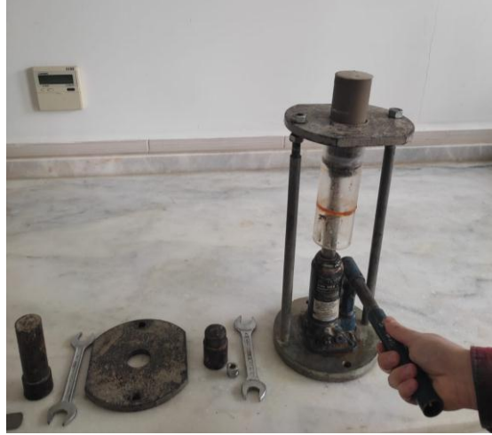
Şekil 4.7. Dondurucudan çıkarılan numunelerin şeffaf hücreden çıkarılma işlemi.
