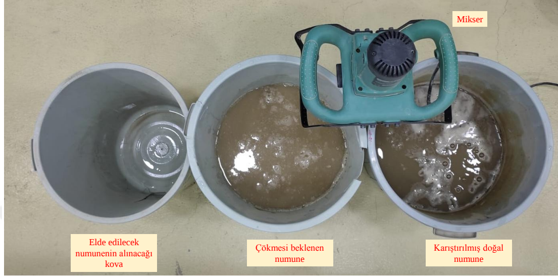
Şekil 4.2. 4. Zemin numunesinin çöktürme tekniği ile elde edilme aşaması.
