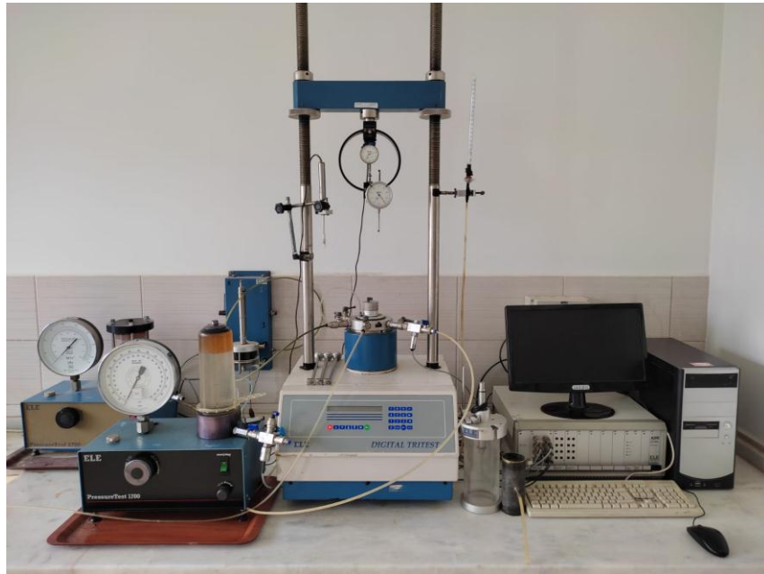
Şekil 4.22. Çalışmada doygun deneyler için kullanılan üç eksenli hücre kesme deney cihazı.
