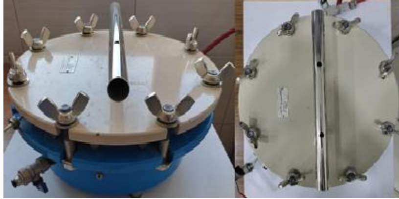
Şekil 4.13. 15 bar basınca dayanıklı basınç plakası hücresi.
