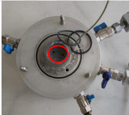
Şekil 4.17. Alt pedestal içerisine açılan helezon biçimli detay.
