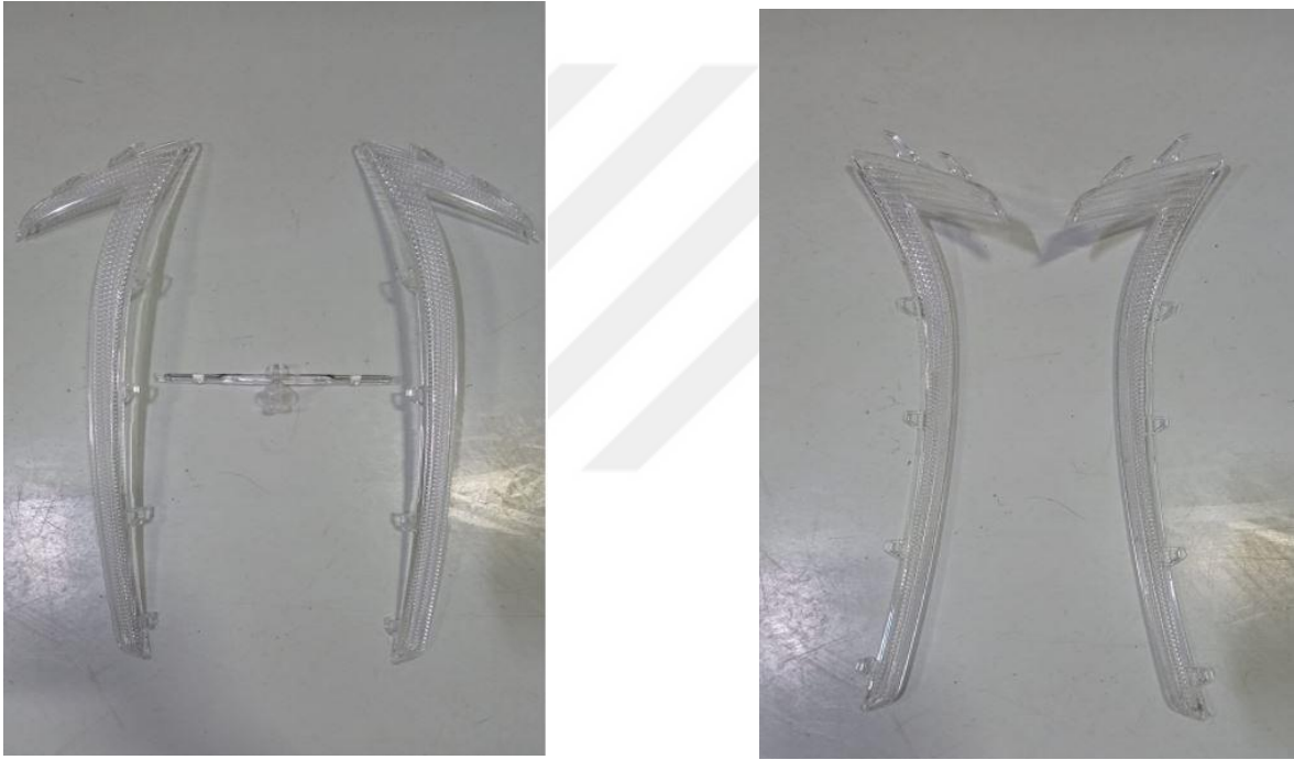
Şekil 4.3: Sağ ve sol lens tırnak hatalı parça görünümü.
