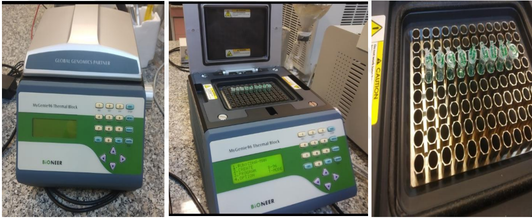
Şekil 17: cDNA sentezi sonrası RT-PZR cihazına yerleştirme.
