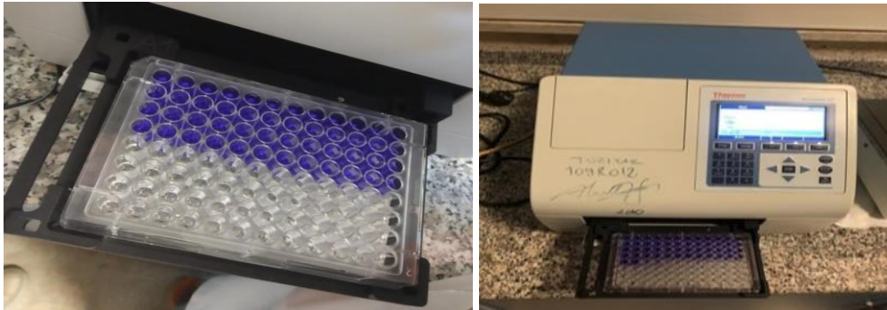
Şekil 13: 630 nm'de plaka okuyucuda ölçüm.
