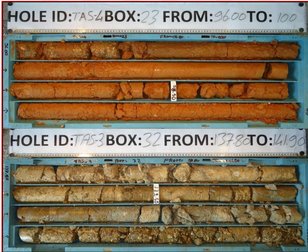
Şekil 6.12. Neojen örtü çökellerin karot görünümleri
