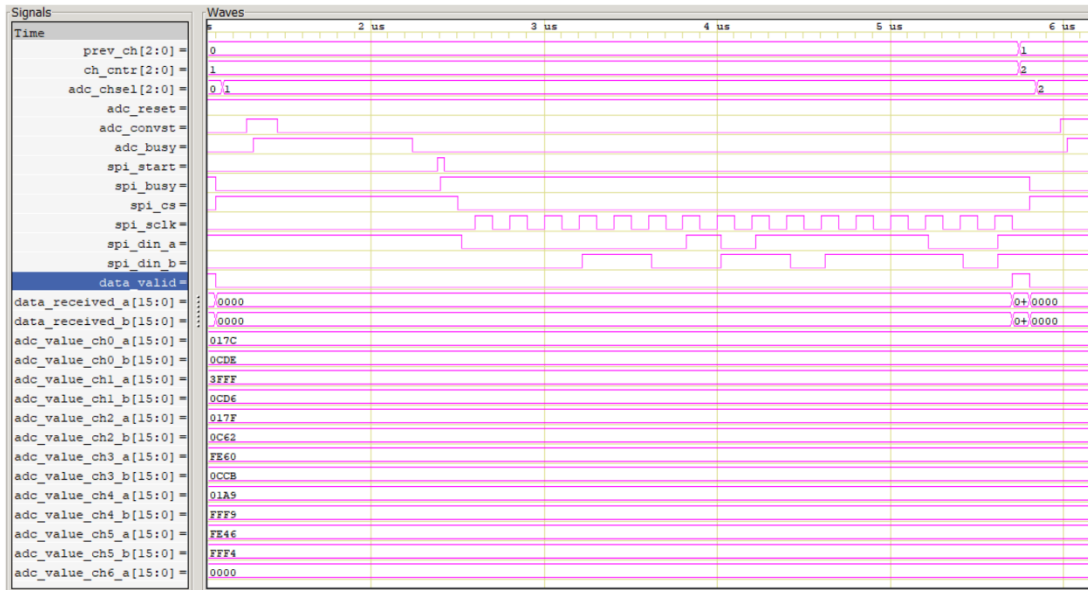
Şekil 2.52 : AD7616 ADC modülü FPGA benzetimi.
