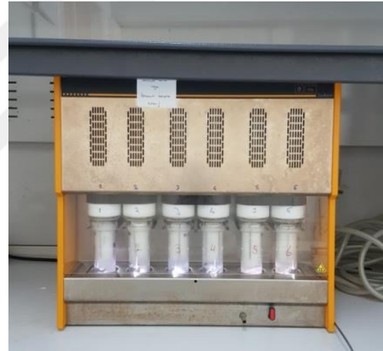
Şekil 3.6 Toplam yağ analizi numune hazırlama ve soxhlet cihazı
