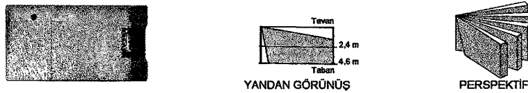
Şekil 4.41. 90° içindeki 5 tane kızılötesi perdesi ile hareketleri algılayan araç [105].
