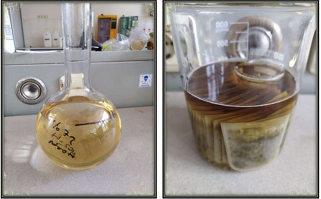
Şekil 8. ADL (Asit deterjan lignin) analizinden görünüm
