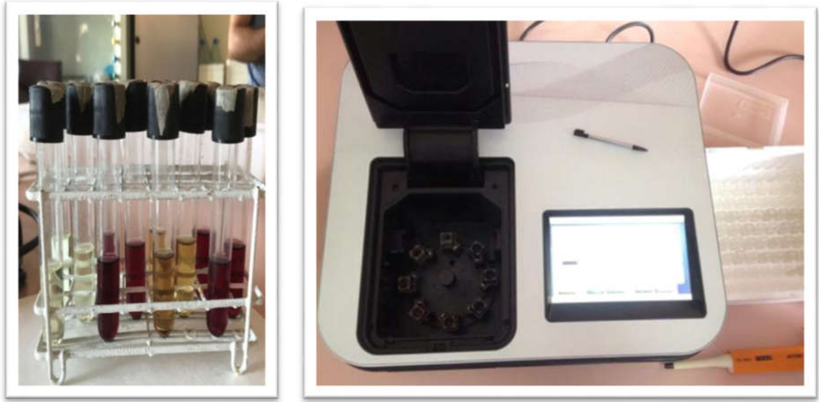
Şekil 9. Örneklerin absorbens değerlerinin Spektrofotometre’de okunması
