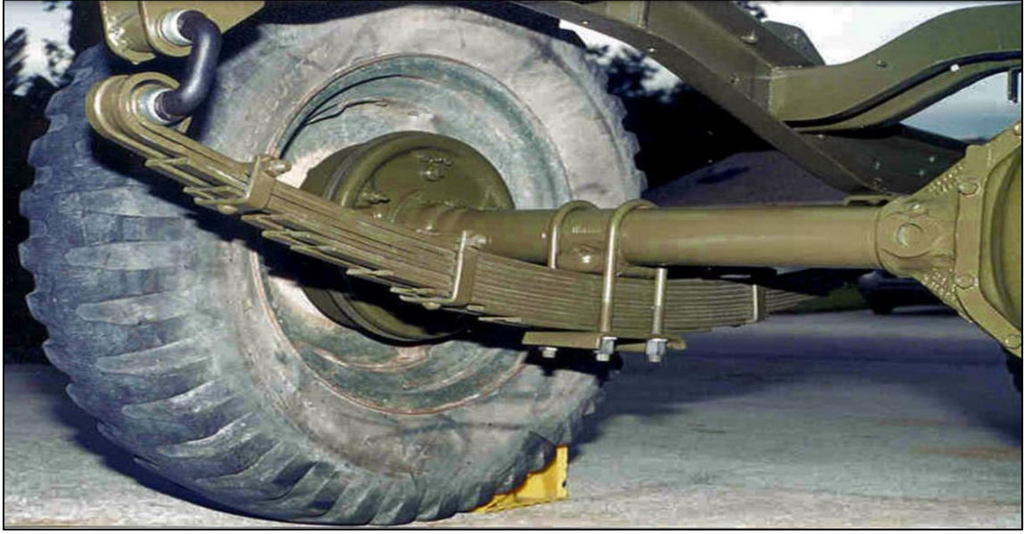
Şekil 3.4. Konvansiyonel yaprak yay görseli.
