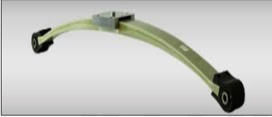
Şekil 3.31. Kompozit yaprak yay görseli
