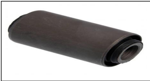
Şekil 3.22. Yaprak yay burcu örnek resim
