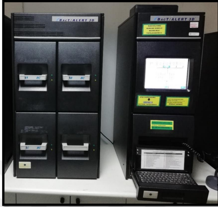
Şekil 3.1. BacT/ALERT 3D kan kültürü sistemi
