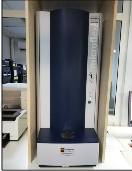
Şekil 3.2. MALDI-TOF MS cihazı
