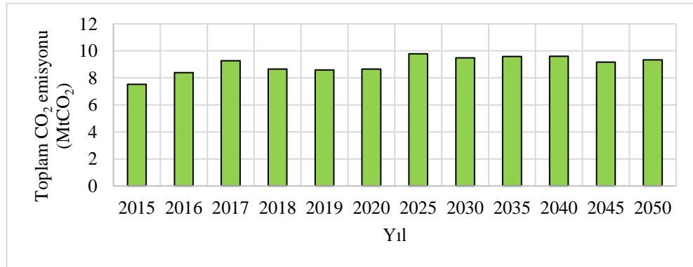
Şekil 9.21: Türkiye'deki kamyonetlerin %100 kablolu hibrit dizel yakıt kullanımı için 2015-2050 yılları arasında toplam CO 2 emisyonu tahmini.
