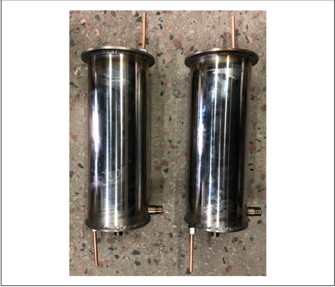
Resim 5.4. Kaynak işlemi ile ısı değiştiricilerin birleştirilmesi
