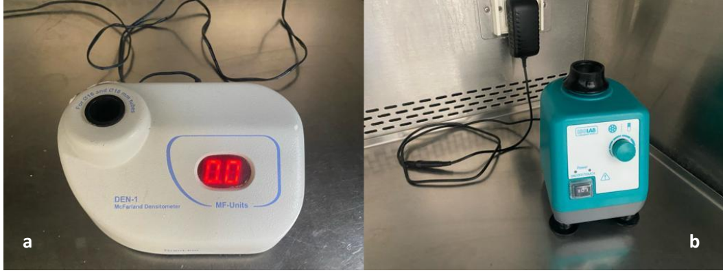
Şekil 2.3. (a) Mikroorganizmaların McFarland 0.5 ( 1.5 \times 10^8 CFU/ml) konsantrasyonlarının ayarlandığı McFarland densitometre cihazı (b) Mikroorganizma vibrasyonunun sağlandığı vortex cihazı
