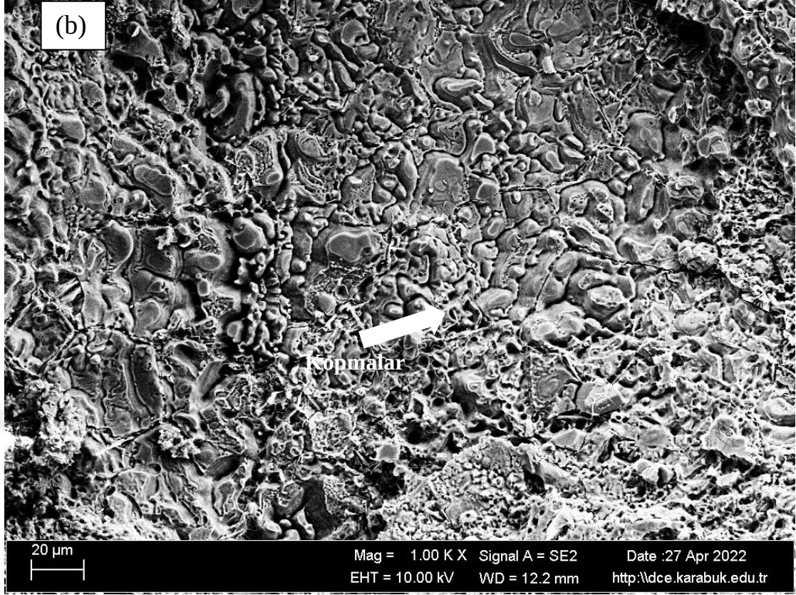
Şekil 6.44. %15 SiC+%0.8 AlN takviyeli AZ91 kompozitin daldırma korozyon sonrası (a) 77X (düşük) büyütme (b) 1KX (yüksek) büyütme SEM görüntüleri.
