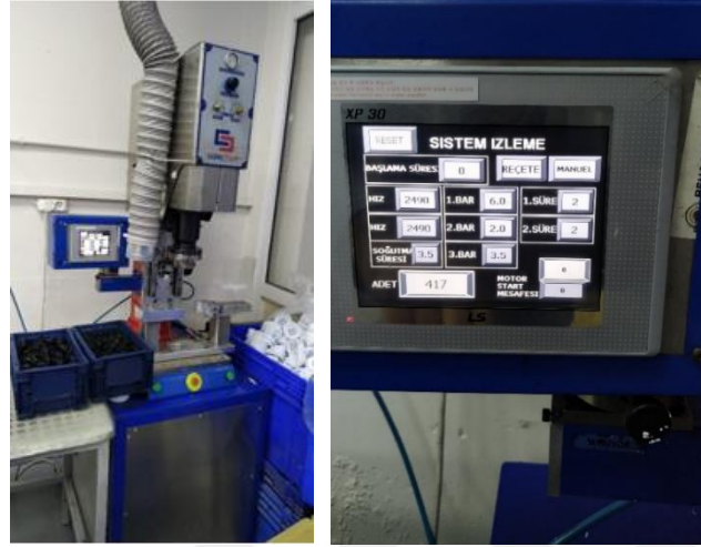
Şekil 5.28. Sürtünme kaynak makinesi ve ekrana girilen parametre.
