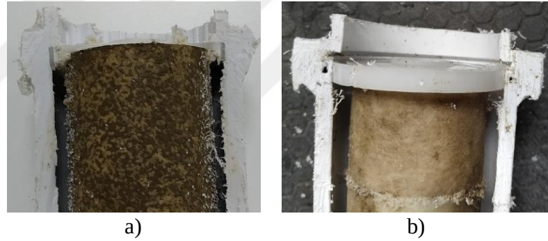
Şekil 6.8. Sediment filtre tıkanma durumu a) Mevcut imalat b) Tasarımı geliştirilen parça.
