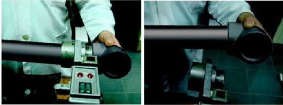
Şekil 2.7. Soket füzyon kaynak tekniğinin uygulanması [25].
