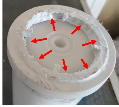
Şekil 3.3. Sediment filtre arızalı eriyik yığılma durumu.
