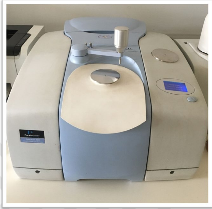
Şekil 2.4. Çalışmada kullanılmış olan Universal Azaltılmış Toplam Yansıtma (ATR) Örnekleme Aksesuarlı Perkin Elmer Spectrum 400 FT-IR / FT-NIR spektrometresi
