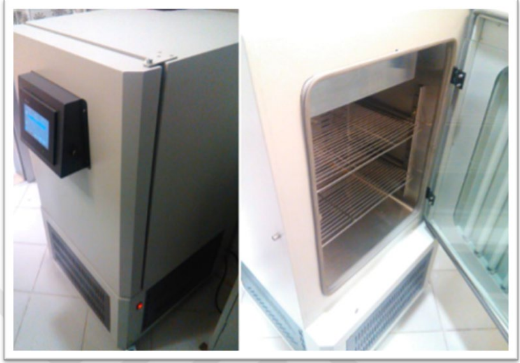
Şekil 2.3. Numunelerin sabit koşullarda bekletildiği iklimlendirme kabini.
