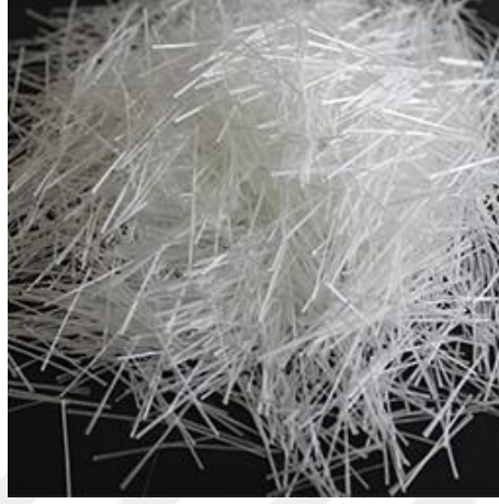
Şekil 3.6 Kırılmış cam elyaf [69]
