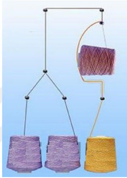
Şekil 3.13 Katlamalı büküm tekniği [72]
