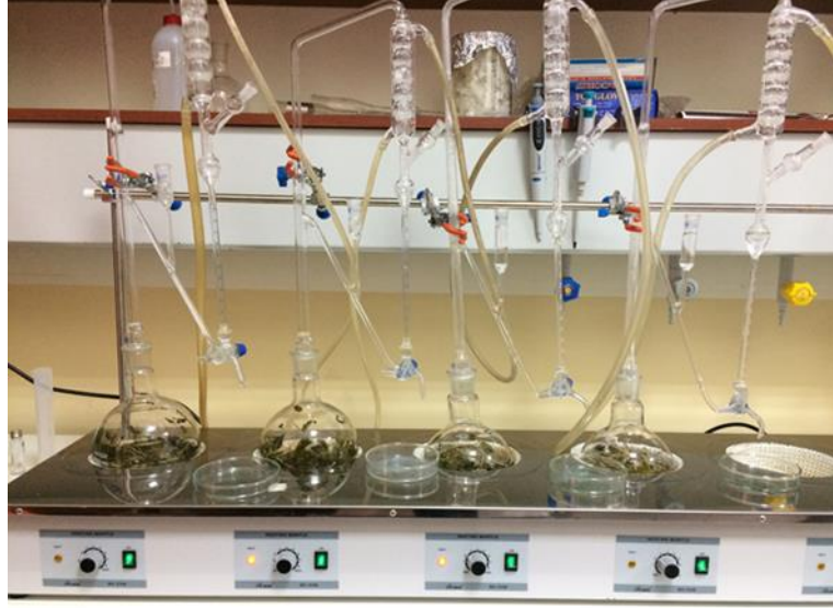
Şekil 3.20. Clevenger aparatı ile bitki uçucu yağının elde edilmesi
