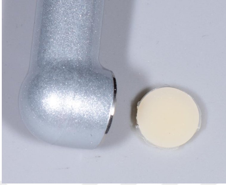
Şekil 3.13. Hazırlanan kompozit rezin numune
