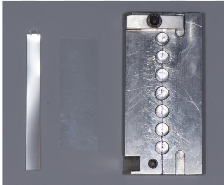
Şekil 3.10. Numune hazırlamada kullanılan metal kalıp, lam ve mylar strip
