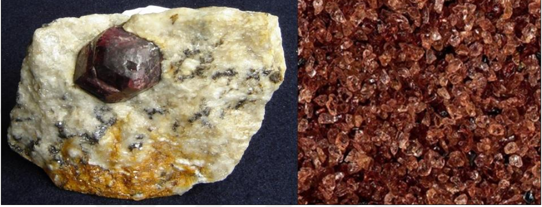
Şekil 1.12. Kayaç içerisinde garnet minerali ve öğütülmüş garnet
