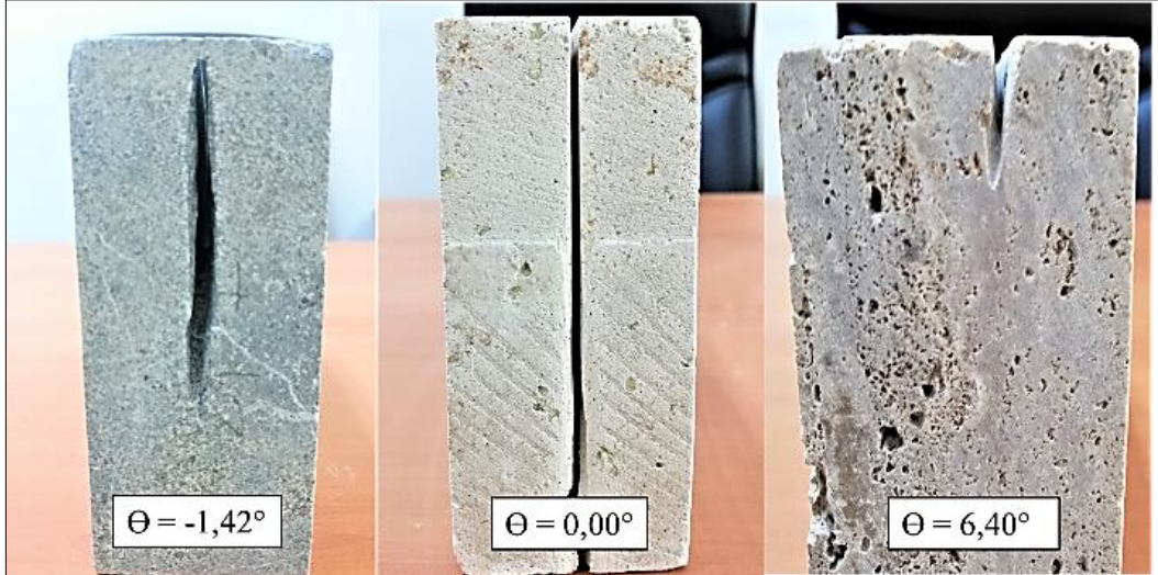
Şekil 3.39. En küçük (negatif), en büyük ve sıfır kerf açısı elde edilen kesimler
