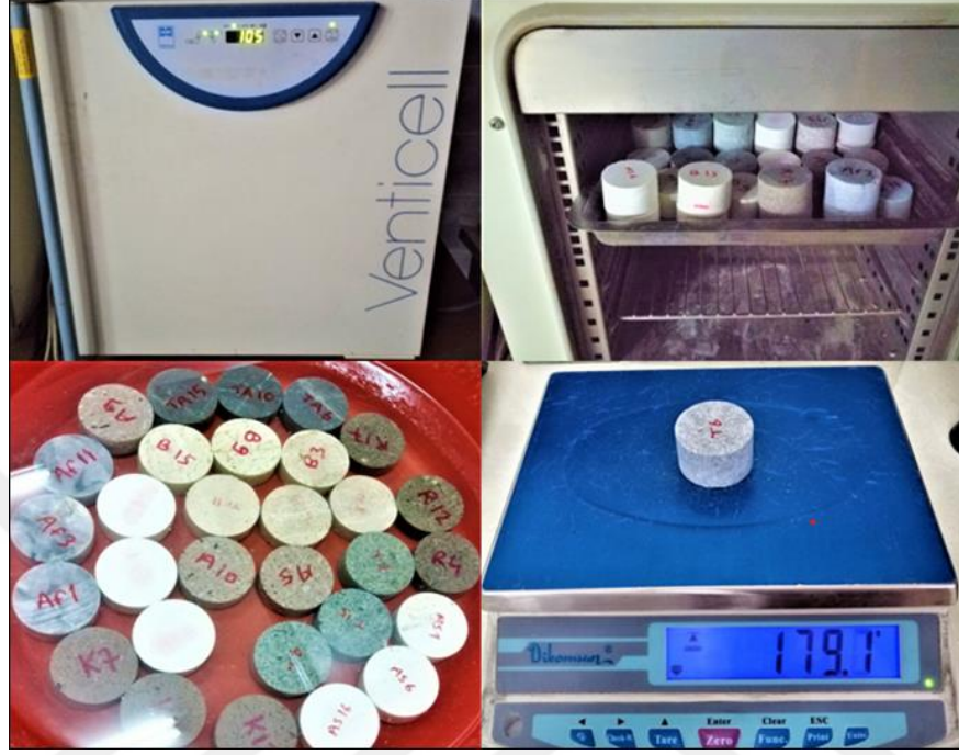
Şekil 2.10. Doğal taşların fiziksel özelliklerinin belirlenmesi
