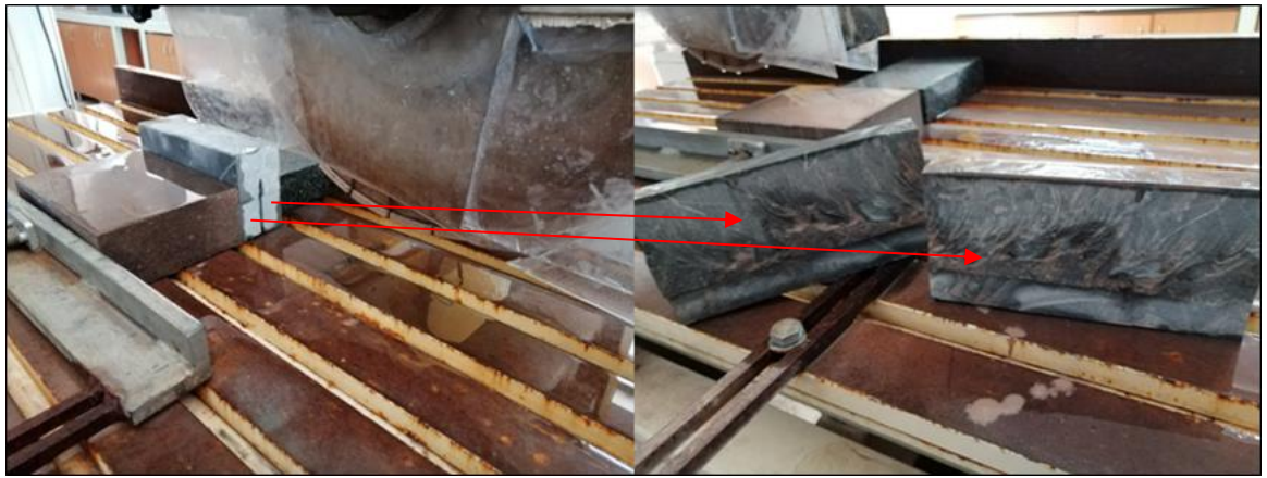
Şekil 2.22. ASJ ile kesilmiş kayaç numunelerinin iç yüzeylerinin dairesel testere ile açılması
