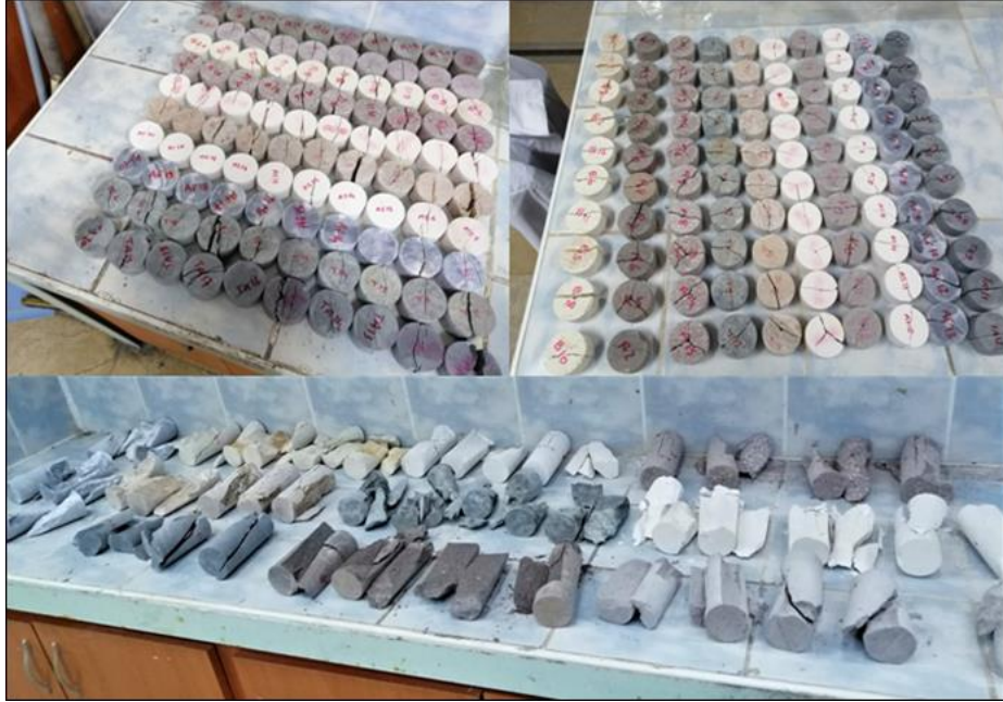
Şekil 2.12. Dayanım deneyleri sonrası kırılmış numuneler
