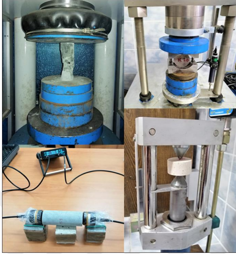
Şekil 2.11. Karot ve disk kayaç numuneleri kullanılarak yapılan deneyler
