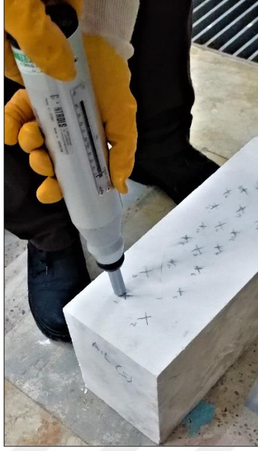
Şekil 2.6. Schmidt çekiçi ile sertlik tayini
