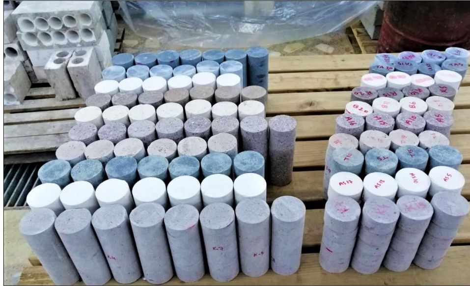
Şekil 2.9. Kayaçlardan hazırlanan karot ve disk numuneler
