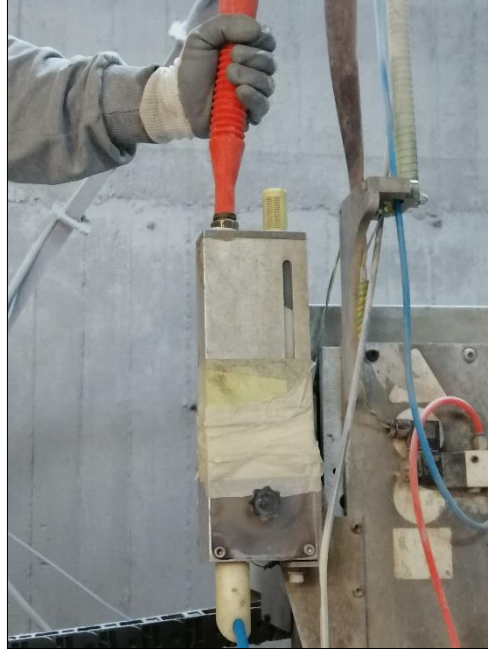
Şekil 2.18. Aşındırıcının hazneye beslenmesi
