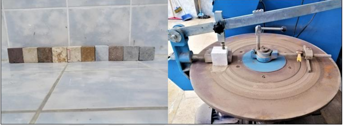
Şekil 2.7. Küp numuneler ve Böhme aşınma deneyi
