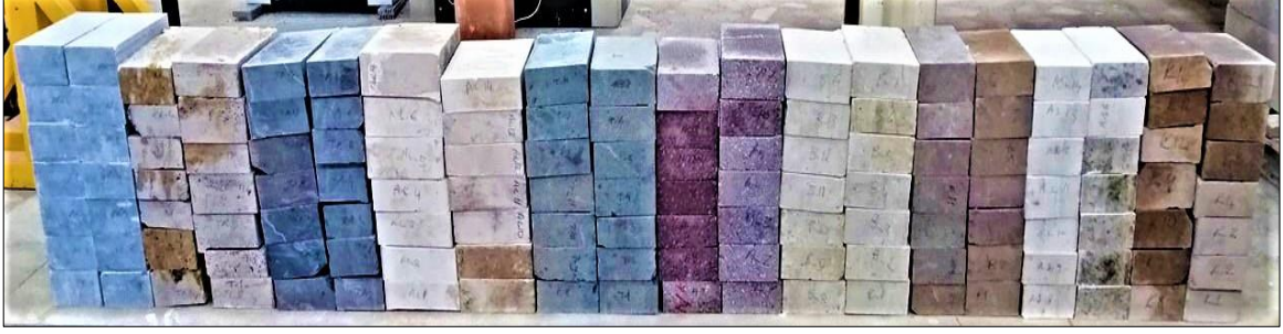
Şekil 2.14. ASJ ile kesime tabi tutulacak numuneler
