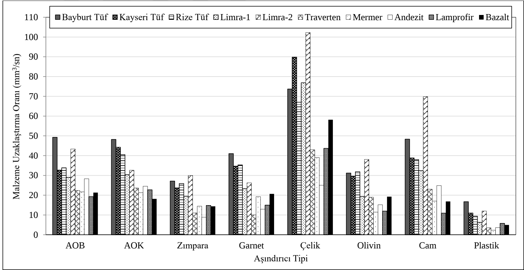
Şekil 3.16. Aşındırıcı tipine göre malzeme uzaklaştırma oranları
