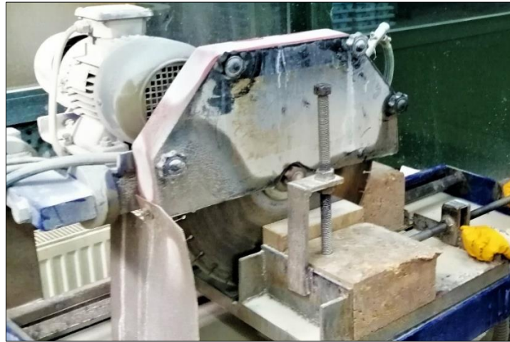
Şekil 2.13. Dairesel testere ile kayaç blok kesimi
