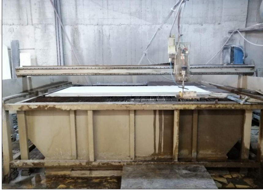
Şekil 2.16. Çalışmada kullanılan ASJ deney düzeneği
