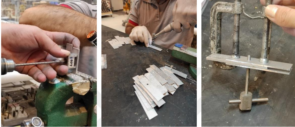
Şekil 5.2. Delme (a), raybalama (b) ve montaj süreçleri (c)
