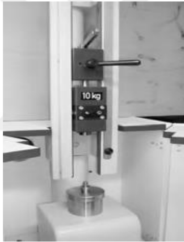
Şekil 2.3. Çekiç düşme test aleti ve ayrıntılı çizimi (Klapötke, 2017).
