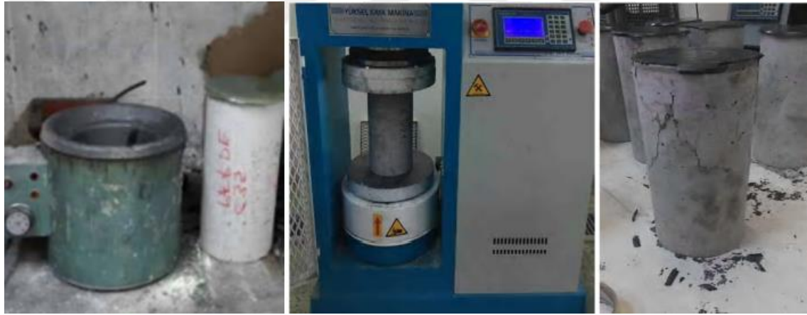
Şekil 2.2. Numunelere kükürt başlık yapılması ve basınç dayanımı deneyi
