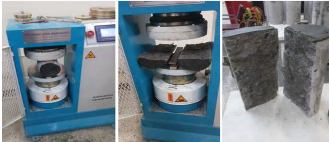
Şekil 2.1. Silindir numunelerin yarmada çekme deneyi
