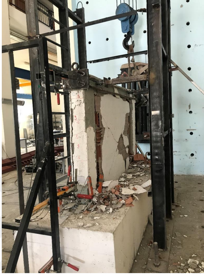
Şekil 3.22. CFRCM-A numunesine yatay yük sonucu dolgu duvardaki deformasyonlar.
