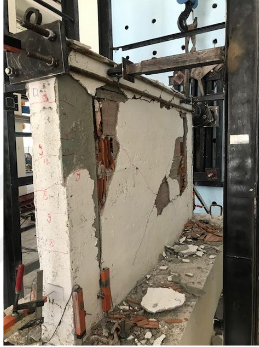
Şekil 3.14. On üçüncü döngü sonunda meydana deformasyonlar
