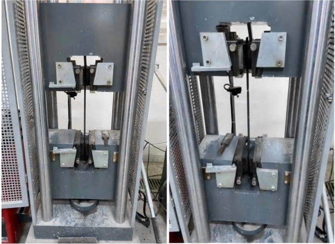
Şekil 2.3. Donatı çekme deneyi
