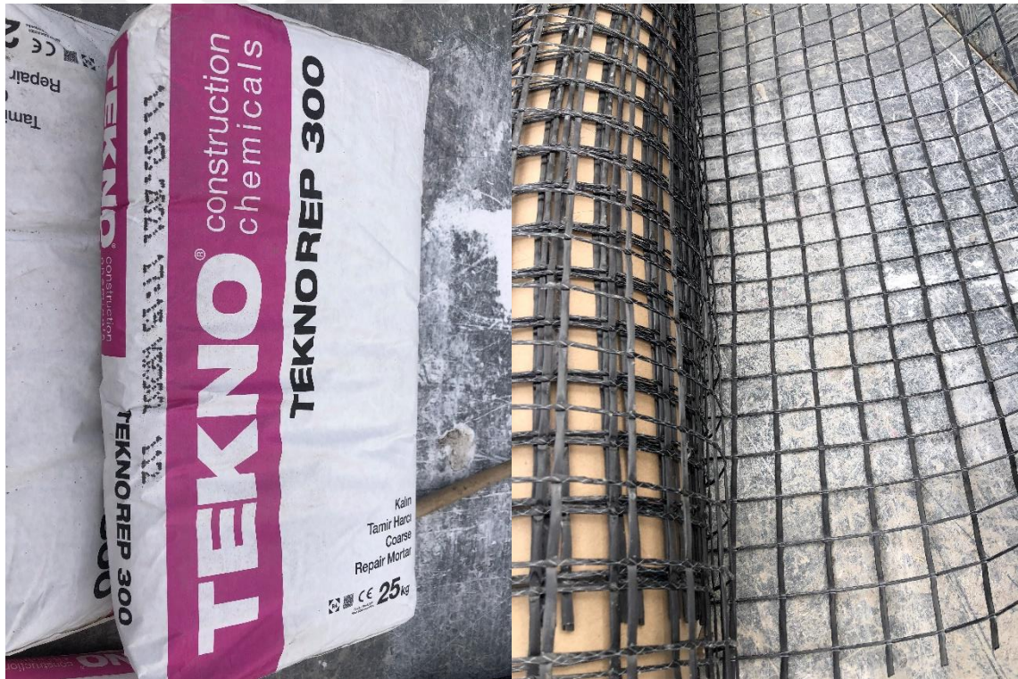
Şekil 2.4. Karbon elyaf esaslı FRCM ağının ve çimento esaslı özel matrisin görünümü
