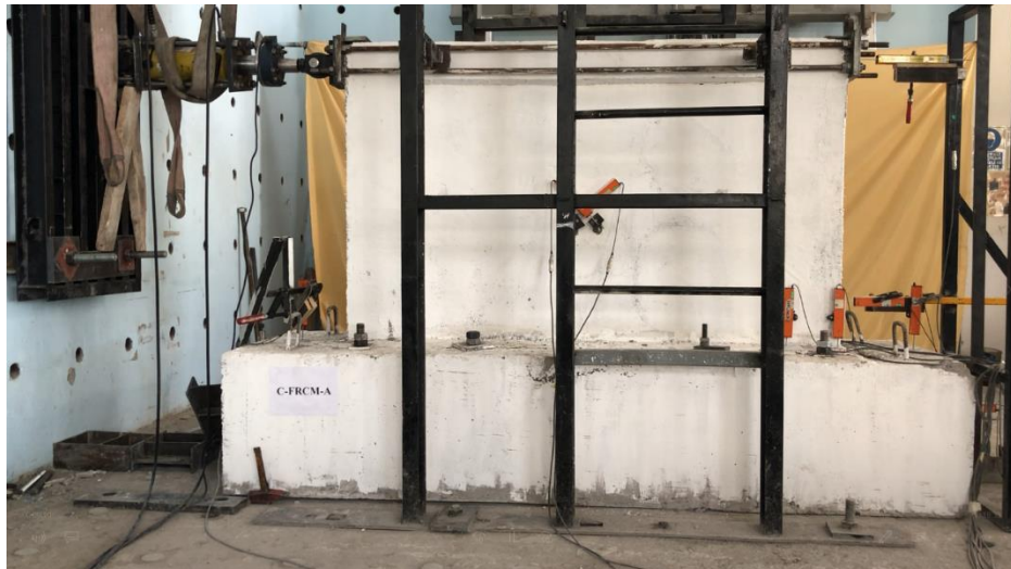
Şekil 3.20. CFRCM-A numunesine yatay yük uygulanması.
