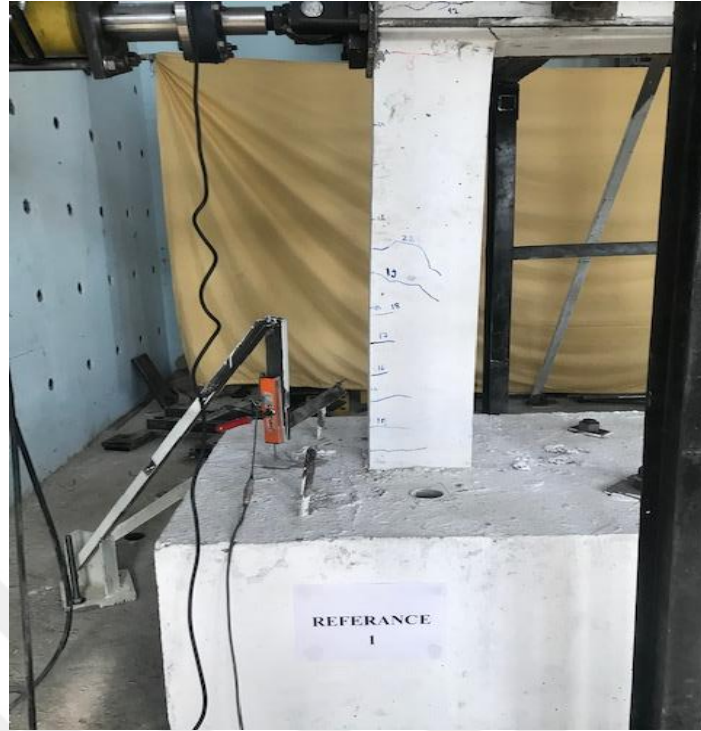
Şekil 3.3. İlk yedi döngü sonunda oluşan çatlaklar
