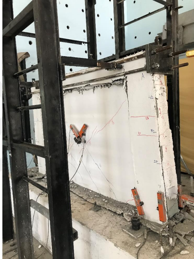
Şekil 3.21. CFRCM-A numunesine yatay yükleme sonucu oluşan çatlaklar.
