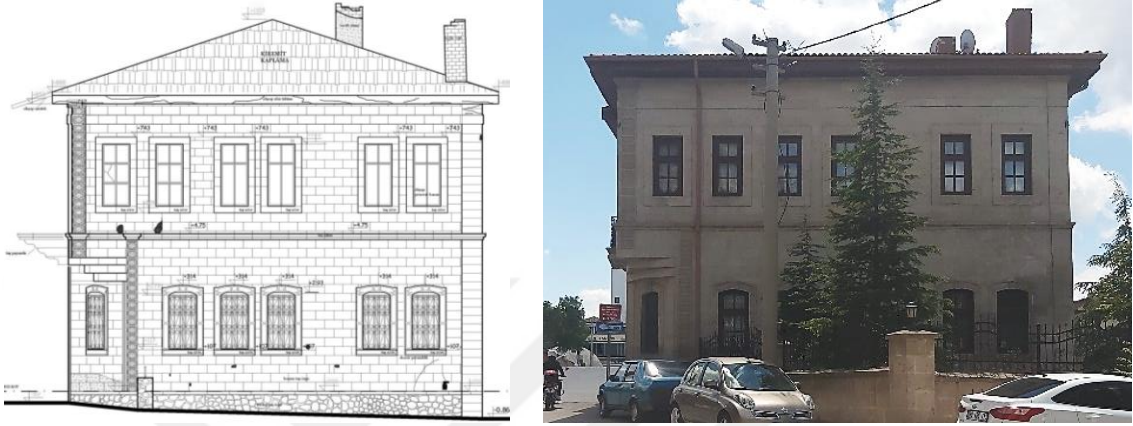
Şekil 4.72. Kuzey cephe rölöve çizimi (Karadayı Yenice, 2012) ve cephenin sokaktan görünüşü
