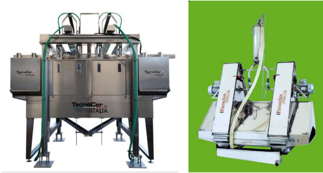
Şekil 2.13. Airless (solda) ve disk (sağda) sır uygulama kabinleri (Anonim, 2020)
