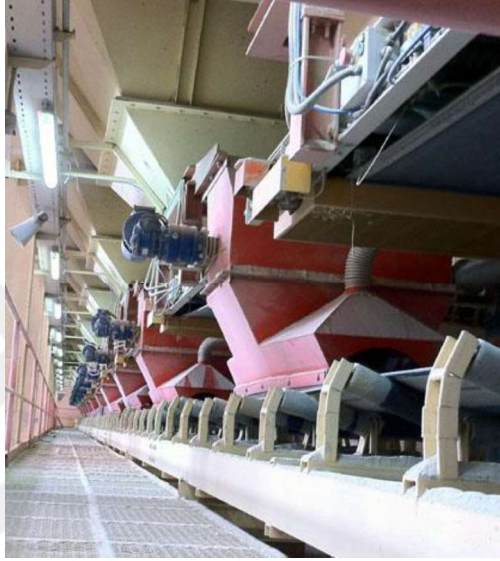
Şekil 2.2. Sürekli Öğütme Sistemlerinde Kullanılan Otomatik Tartım-Aktarım Sistemleri (Anonim, 2012)
