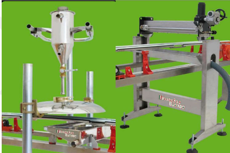
Şekil 2.12. Kampana (solda) ve vela (sağda) sır uygulama ekipmanları (Anonim, 2020)
