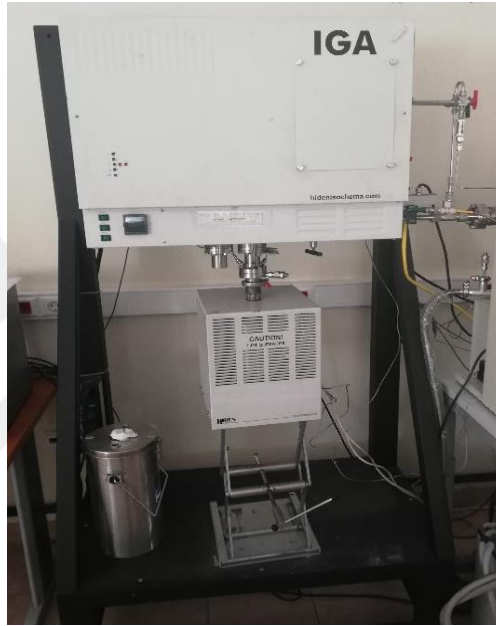
Şekil 6.12 BET yüzey alanı ölçümlerinde kullanılan IGA sistemi
