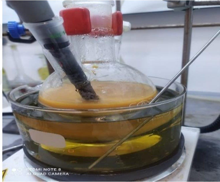
Şekil 6.14 Çöktürme yöntemi ile hazırlanan ve su banyosunda karıştırma altında bekletilen çözelti
