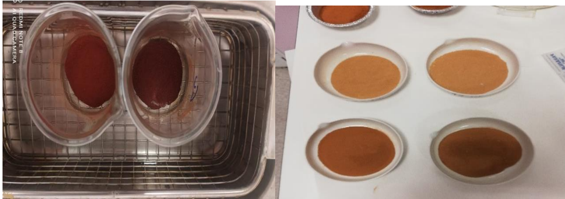
Şekil 6.13 Emdirme çalışmasına ait ultrasonik banyoda kurumuş ve kalsine edilmiş katalizörler
