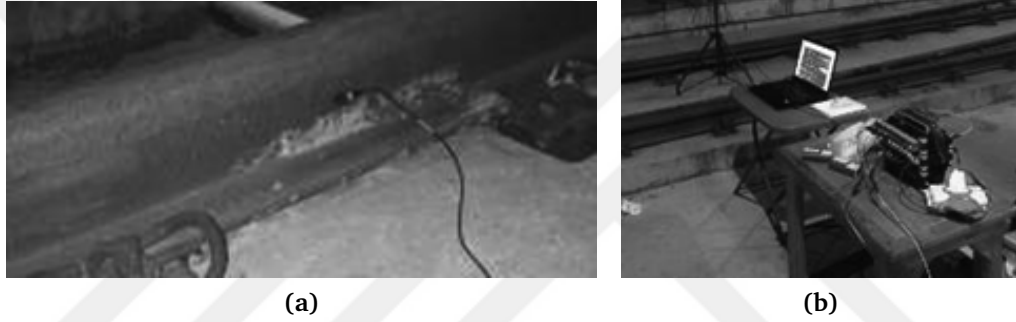
Şekil 4.18 a)Rayın ortasındaki ivmeölçer b)Veri toplama sistemi
