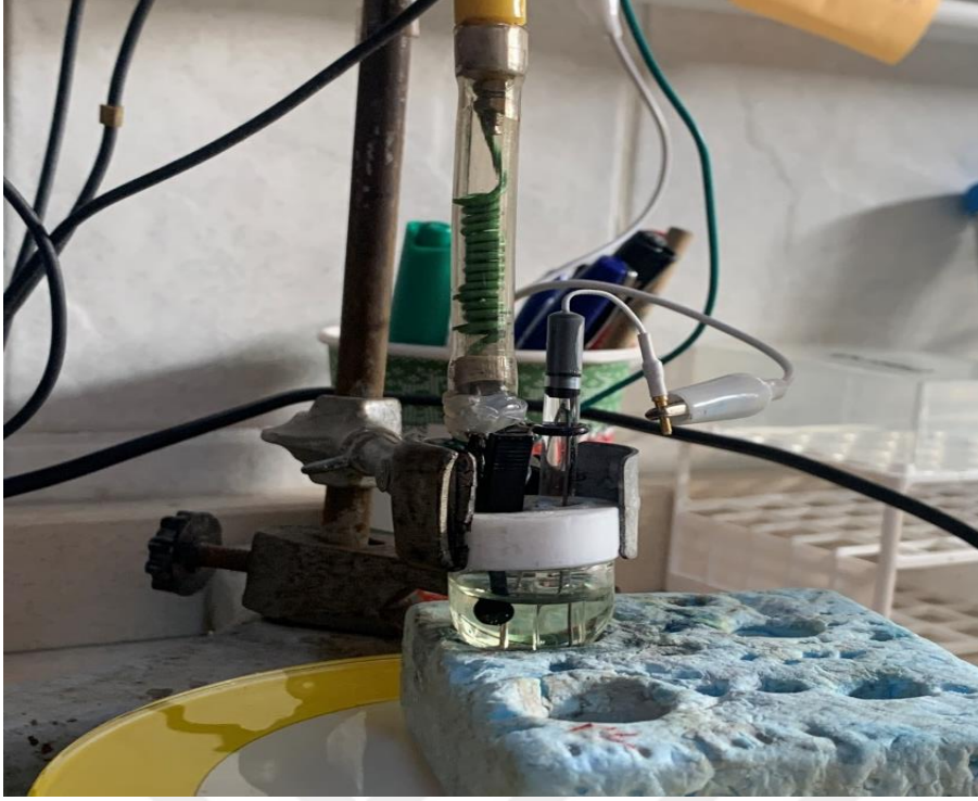
Şekil 3.2. Hazırlanan çalışma elektrodu ile üçlü elektrot sistemi
