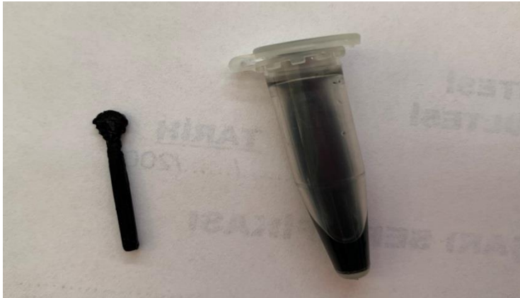
Şekil 4.6 Sonikatörde aseton ile muamele edilen elektrotlar
