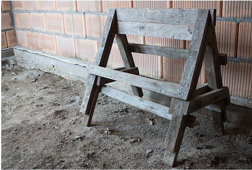
Şekil 3.18. Ahşap iskele örneği
