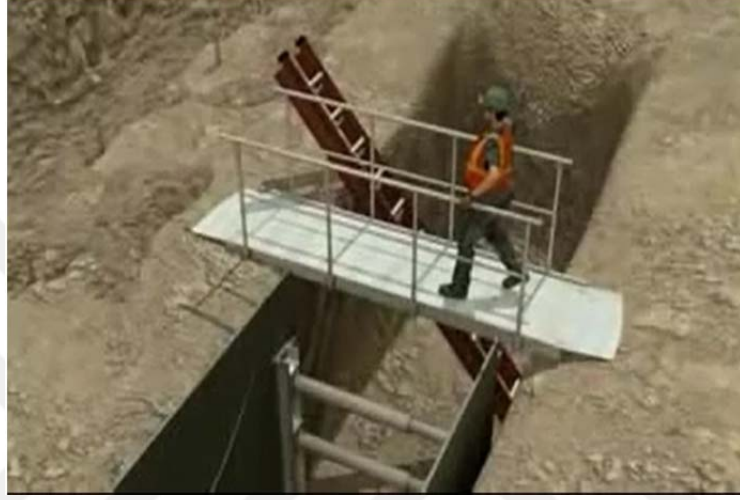
Şekil 3.3. Kazı üzerinden geçit örneği
