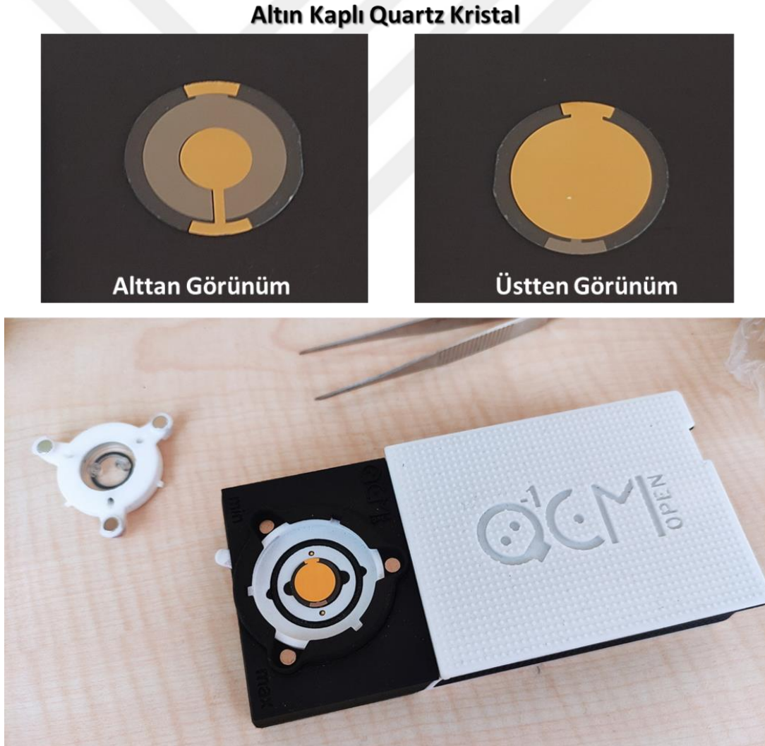
Şekil 3.2. Altın kaplı quartz kristalin görüntüsü ve OpenQCM -1 cihazına yerleştirilmesi.
