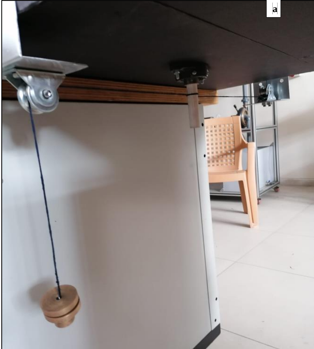
Resim 3.4. Prony fren dinamometresinin a) deneysel ve b) şematik gösterimi
