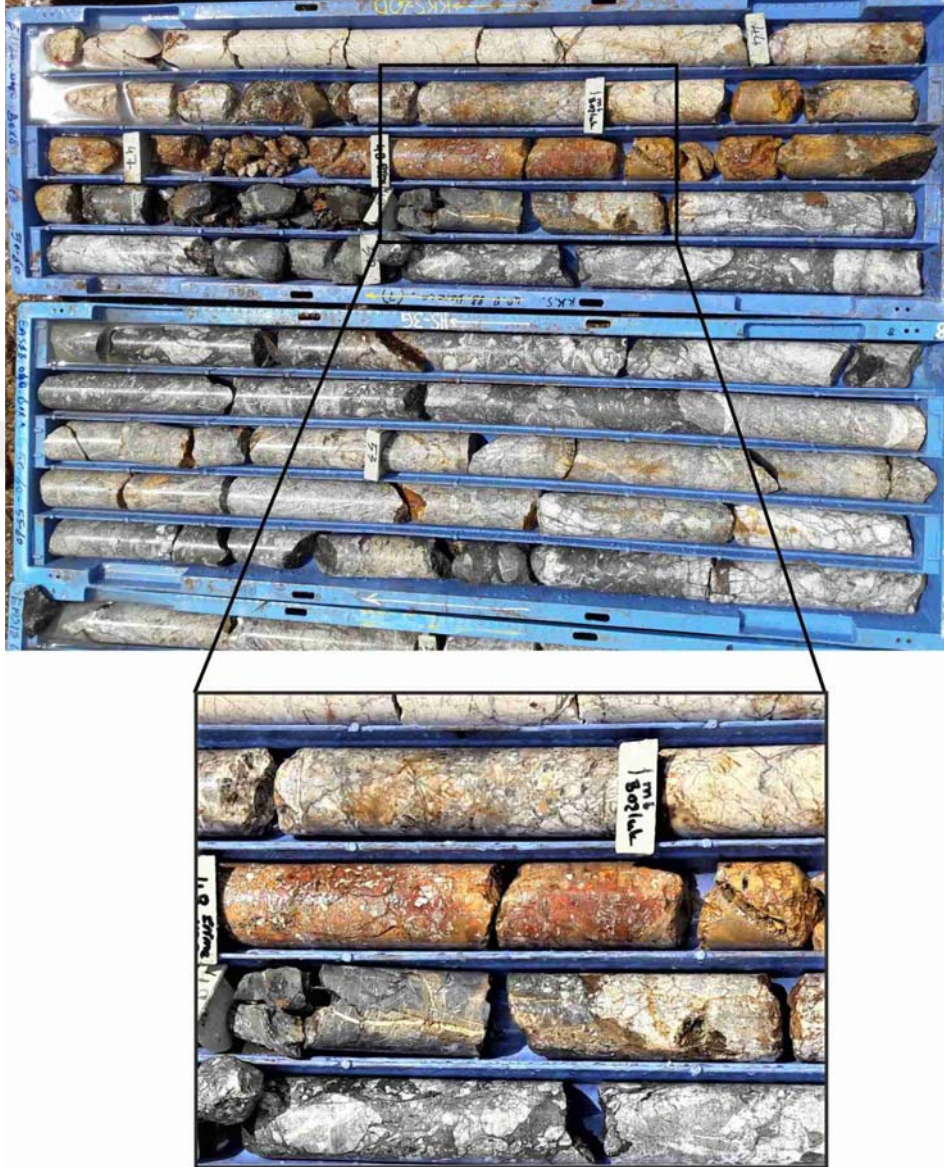
Şekil 4.24. Breşik yapılı demir oksitli simitsonit ve koyu renkli sfalerit.
