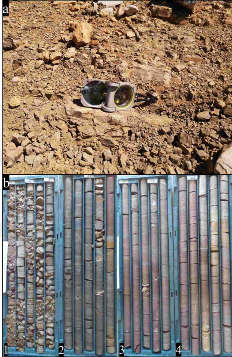
Şekil 4.12. a) Yavça formasyonuna ait silttaşı-kumtaşı arazi görüntüsü, b) Sondajda kesilen Yavça formasyonuna ait birimler; (1)silttaşı-kumtaşı, (2-3)yeşil-bordo renkli killi kireçtaşı, (4)geçişli olarak krem kireçtaşı.
