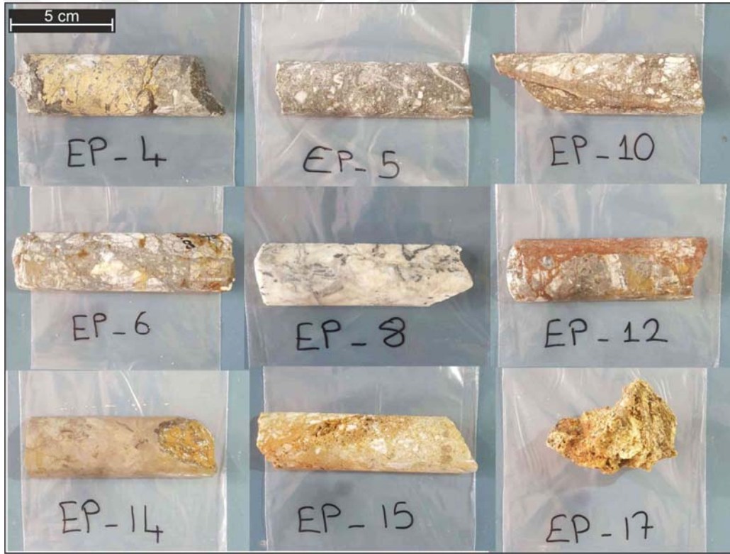
Şekil 4.27. EP-4-EP12 Sfalerit, galenit, hematit, demiroksit damar-dolgulu breşik kireçtaşı ve cevher örnekleri, EP-14 Masif Sfalerit, EP-15, EP17 demiroksitli simitsonit.
