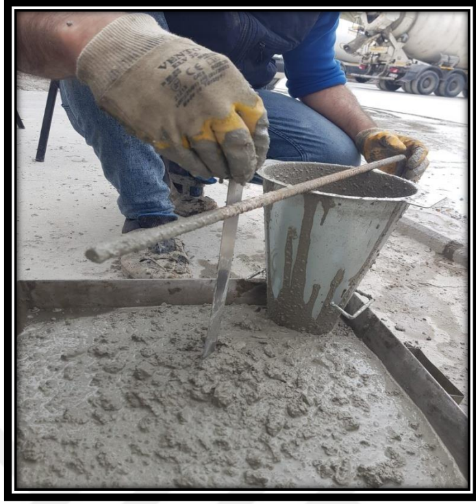
Şekil 4.6 Slump (Çökme) deneyi
