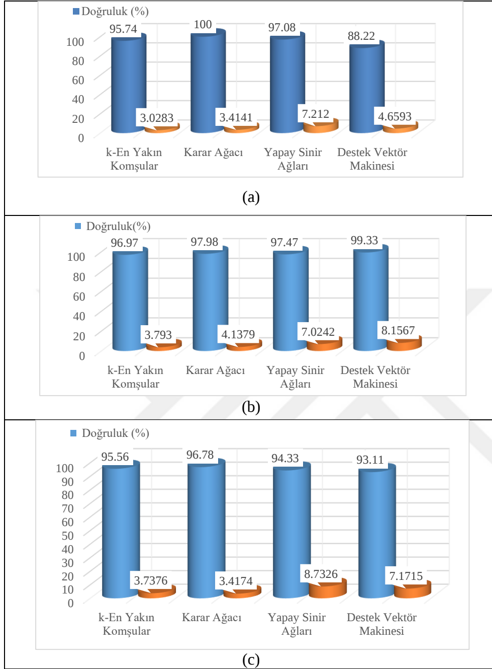
Şekil 6.10. Test süresi ve doğruluk grafikleri (a) HTTP saldırısı, (b) DNS saldırısı, (c) ICMP saldırısı
