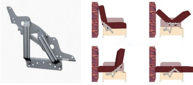
Resim 3.3. Çekyat mekanizması ve çalışma prensibi [21]
