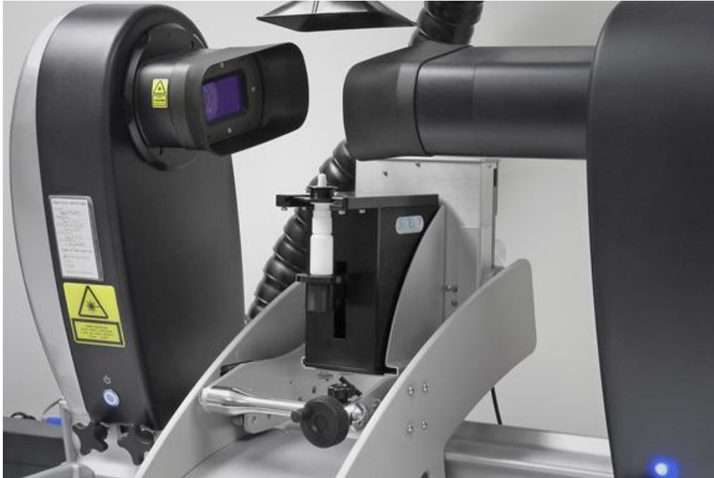
Şekil 2.1. Nazal pompa spreylelerinin karakterizasyonu için Malvern Spraytec sistemi
