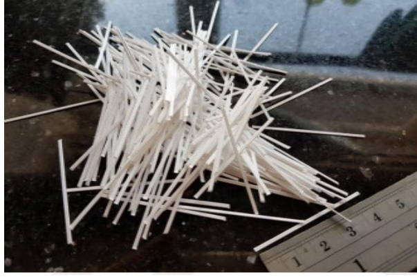
Şekil 5. Makro sentetik fiber donatı (Aydoğdu, 2019).
