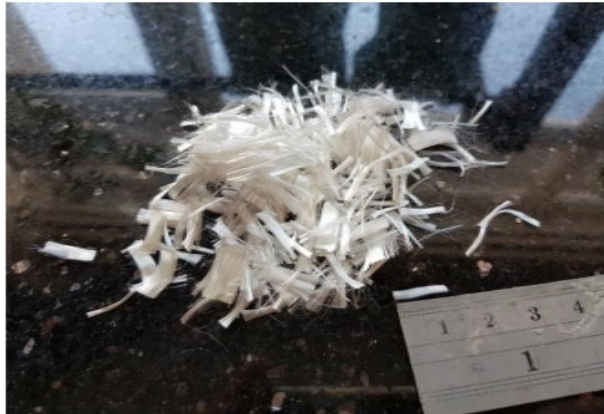
Şekil 6. Mikro sentetik fiber donatı (Aydoğdu, 2019).
