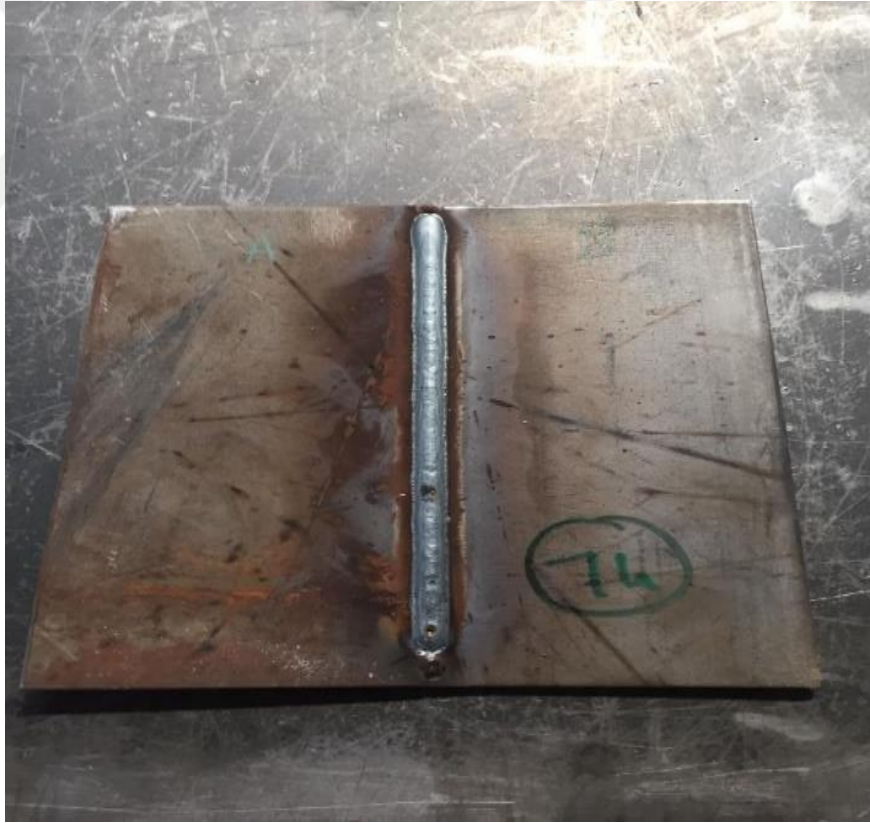
Şekil 6.9 DD11 ve DD13 levhaların kaynaklı birleşimi
