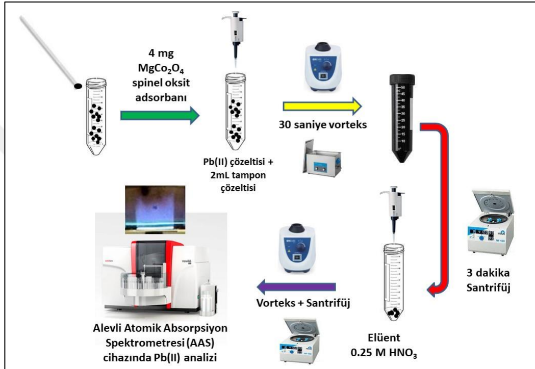
Şekil 2.2. Geliştirilen KFME yönteminin şematik diyagramı
