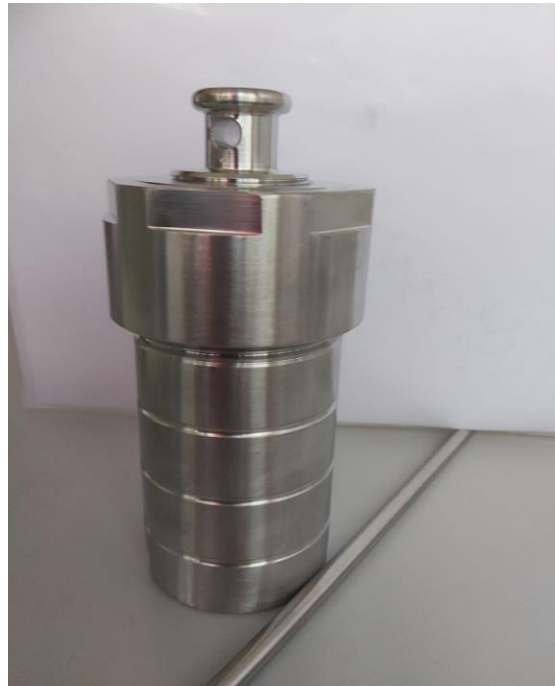
Şekil 2.1. Hidrotermal sentez ünitesi
