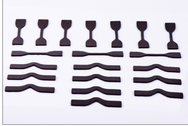
Şekil 3.16. Ağırlıkça %3 bor ilave edilmiş çekme ve yırtılma testi numuneleri
