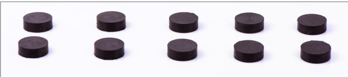
Şekil 3.15. Ağırlıkça %3 bor ilave edilmiş sertlik testi numuneleri
