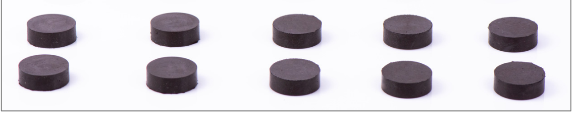
Şekil 3.13. Ağırlıkça %1 bor ilave edilmiş sertlik testi numuneleri
