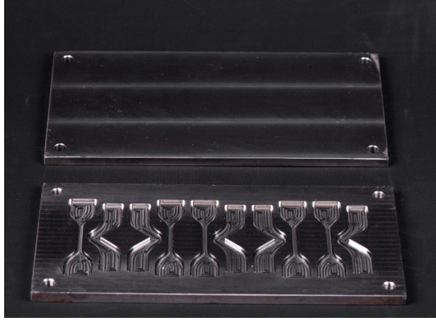
Şekil 3.7. Çekme ve yırtılma testi için hazırlanan paslanmaz çelik kalıp
