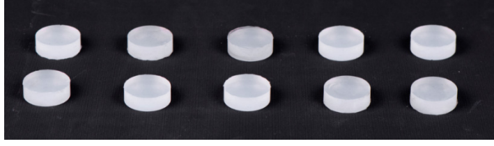
Şekil 3.11. Sertlik testi için kullanılacak numuneler
