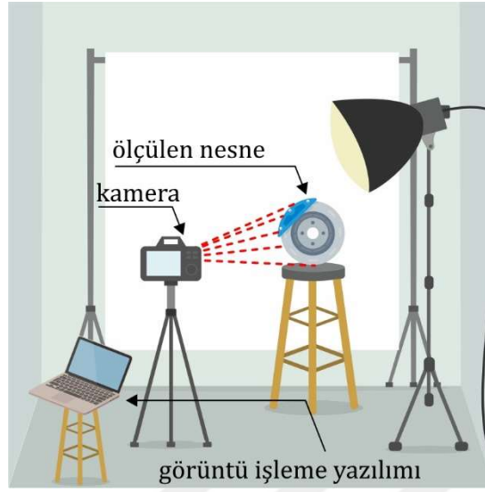
Şekil 3.5. Fotogrametrik ölçüm düzeni (şematik)
