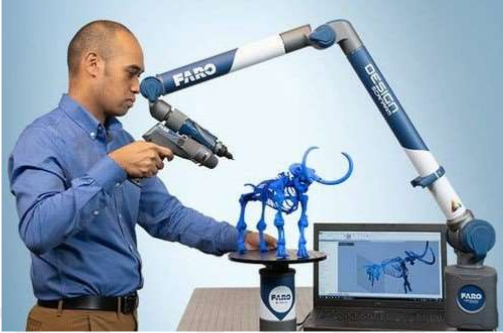
Şekil 3.2. Faro Design ScanArm 2.0 koordinat ölçüm cihazı (IndiaMART, 2019)
