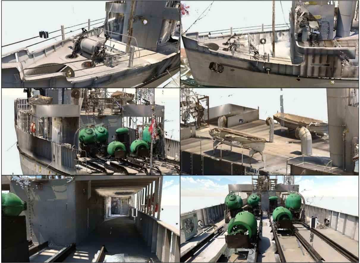
Şekil 4.1. Yersel lazer tarama detay alımları
