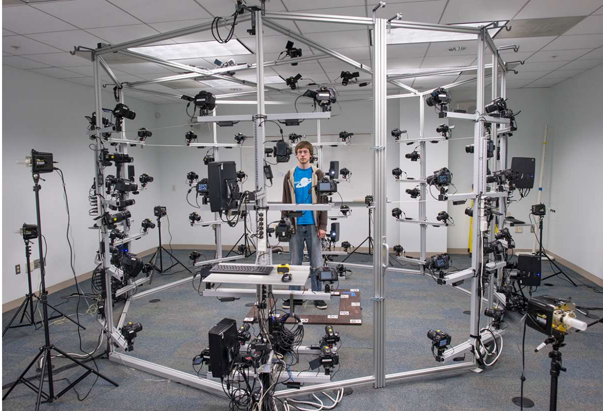
Şekil 3.4. Fotogrametrik ölçüm düzeneği (The New School, 2017)
