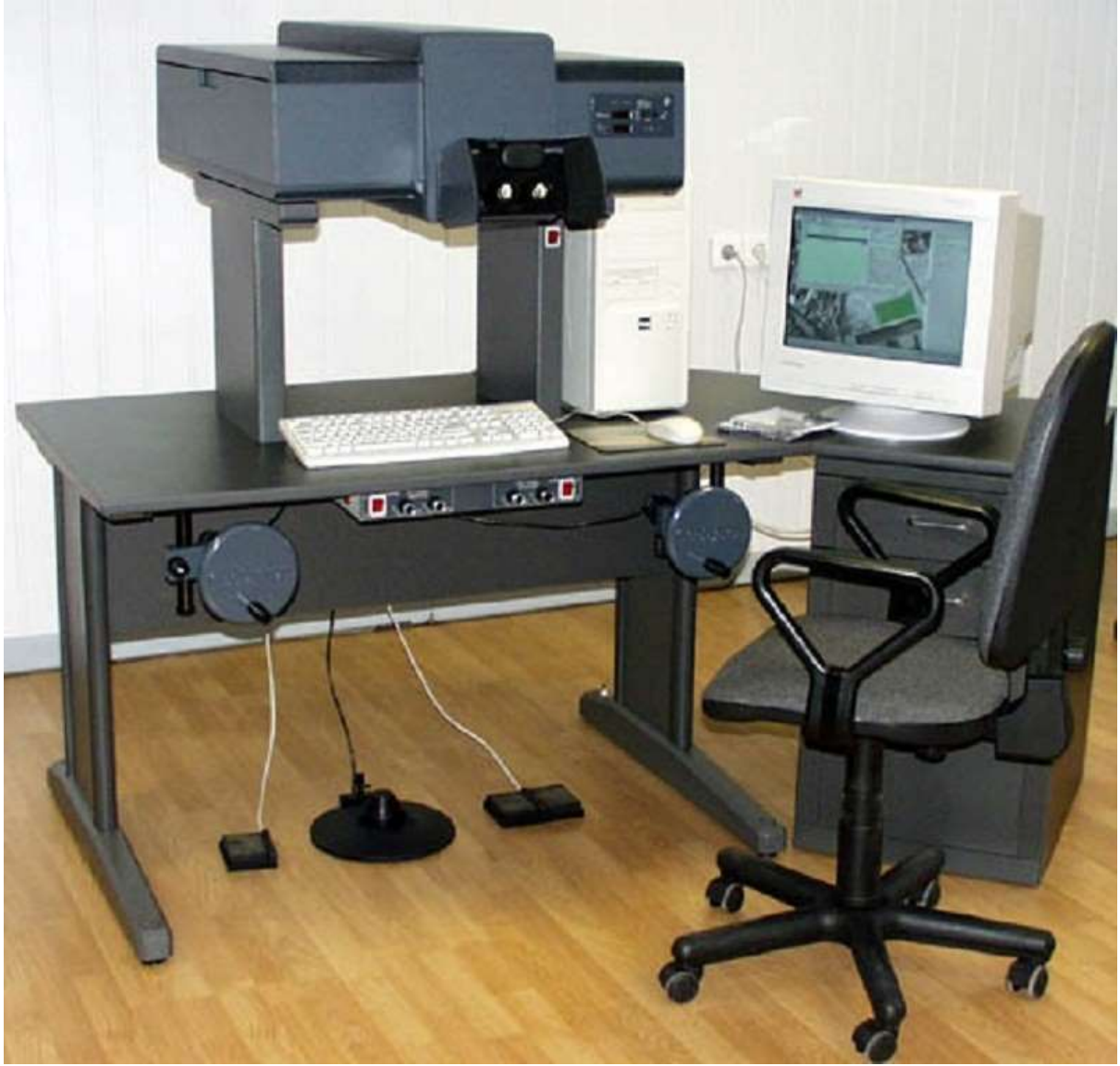
Şekil 3.7. Analitik fotogrametrik istasyon (Singh, t.y.)
