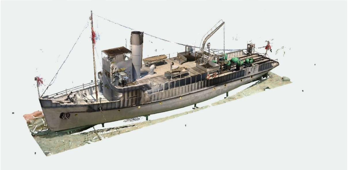
Şekil 3.22. Yoğun nokta bulutu verisi (lazer)
