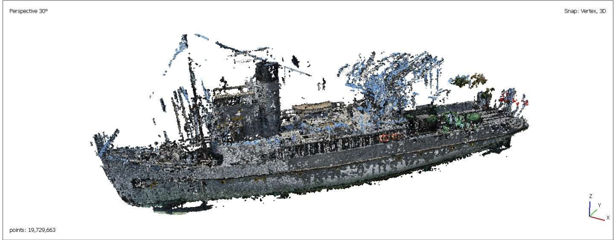
Şekil 3.16. Yoğun nokta bulutu verisi (mobil)
