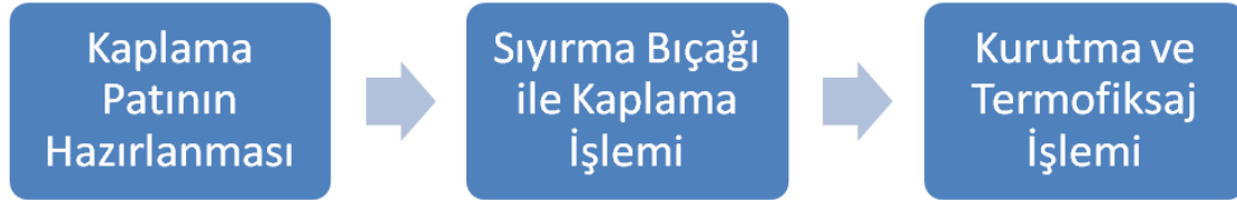
Şekil 3. 3. Kaplama İşlem Adımları.
