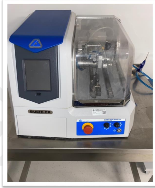
Şekil. 3.2 Yüksek Devirli Elektrikli Testere Buehler Introduces IsoMet™ High Speed - An Advanced Precision Cutter.
