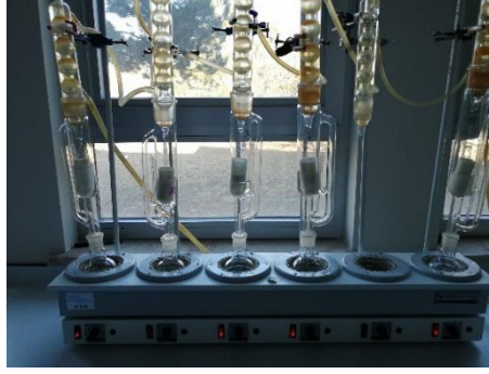
Şekil 3.5. Soxhelet cihazından yağ elde edilmesi
