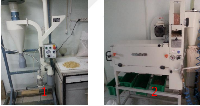
Şekil 3.1. (1) Kavuz soyma cihazı (Codema, Inc., Minneapolis, USA) (2) Dokaj cihazı
