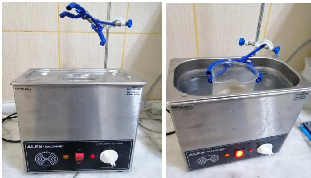
Şekil 2.9. Ultrasonik karıştırıcı ve SiC nanopartiküllü reçinenin ultrasonik karıştırıcıda karıştırılması.
