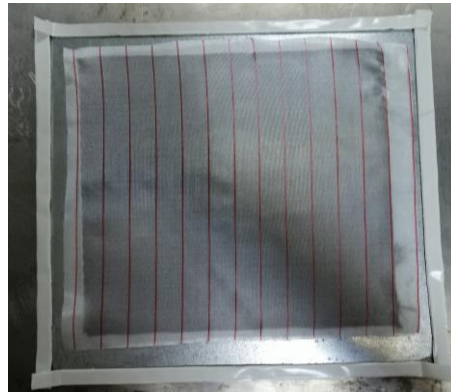
Şekil 2.4. Katman halindeki karbon fiberlerin üzerine ayırıcı soyma kumaşının (infüzyon filesi) yerleştirilmesi.
