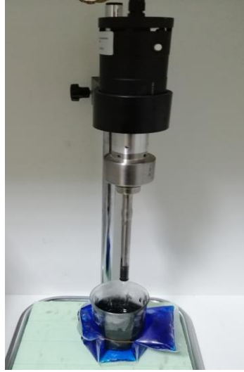
Şekil 2.14. Ultrasonik homojenizasyon işlemi için beherin soğutucu jel ile kaplanması ve grafen nanopartiküllü reçinenin karıştırılması.
