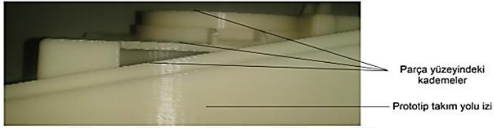
Şekil 1.14. Prototip imalatından sonra parçada oluşan kademeler [33]
