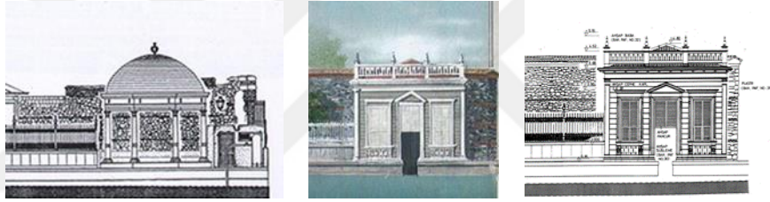
Şekil 8.36: Deniz Hamamı rölöve, restitüsyon ve restorasyon görünüşleri (Avunduk, 2002)
