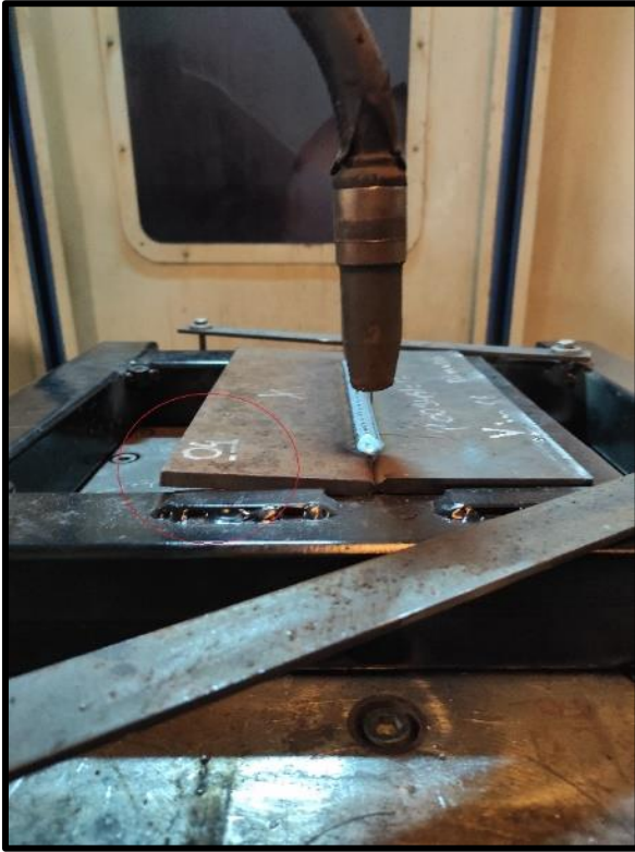
Resim 6.5. Distorsiyona uğrayan deney numunesi
