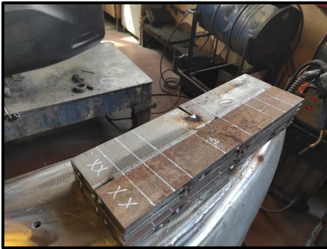
Resim 6.9. Testere ile kesime hazır puntalanmış numuneler
