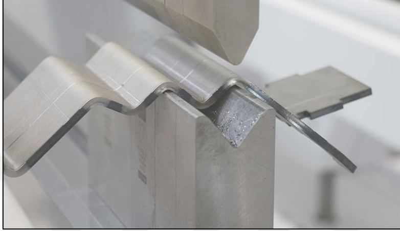
Şekil 2.2. Pres makinesiyle şekil verme işlemi (URL-6, 2021)
