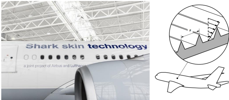
Şekil 1.3: Köpekbalığı derisi ile kaplanmış uçak.
