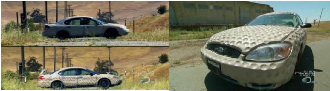
Şekil 1.1: Pürüzsüz Yüzey ve Golf topu çukuru deseni ile kaplanmış otomobil.
